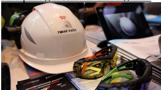
Программно-аппаратный комплекс «Умные каски» предназначен для контроля в режиме реального времени соблюдения техники безопасности сотрудниками, обязанными носить защитную каску на производстве.
